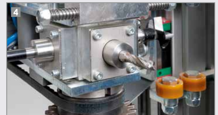
Frees van 8 mm voor boor- en beperkte freestoeppassingen
