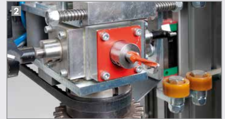
Linkse boor van 5 mm voor rijboringen
