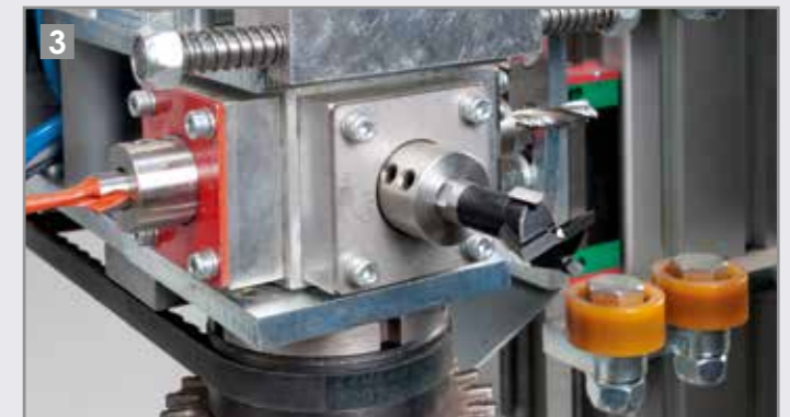
Boor van 20 mm voor minifix-systeem
